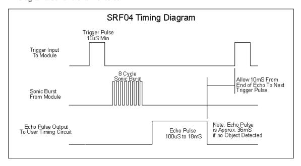
En la tarjeta TCEPI se utilizan los pines especificados en el fichero sonar.h: SONAR1 --> RECEPCION --> RD5; TRIGGER --> RD4
