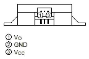
En este caso la señal Vo se corresponde con la tensión que hay que medir en nuestro circuito. Para ello se configura un conversor A/D de la placa. en el fichero gp2.h.
