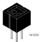
Su funcionamiento se basa básicamente en la reflexión. Tiene por un lado un diodo emisor de infrarrojos (o sea, que emite luz no visible), y por otro lado un fototransistor sensible a la luz infrarroja. El sensor diferencia entre blanco y negro por la cantidad de luz reflejada (blanco refleja más que negro). Por lo tanto podemos adivinar que para este sensor no es lo mismo un negro mate que un negro brillante, es mas: por
