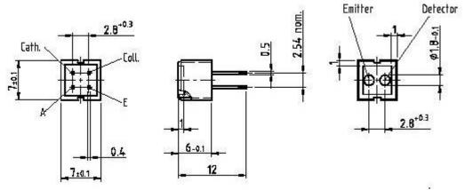
Según la imagen superior y figura de la izquierda, las letras del sensor quedarían a la derecha.
